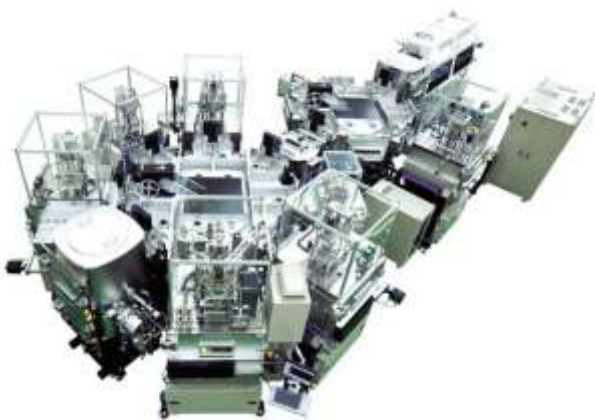
<그림 4> 중소형 OLED 생산에 적용되는 OLED 증착기 System
