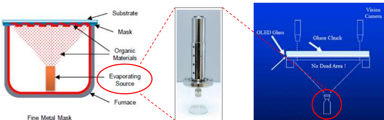
<그림 3> OLED 증착기는 크게 진공 Chamber와 Souce 증착부로 구분
